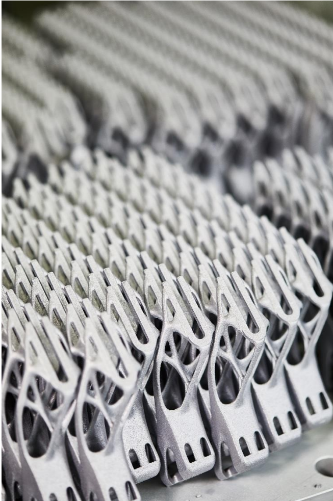
Bild 3: Additive Gleichteilserienfertigung bei der BMW Group. © BMW Group.
